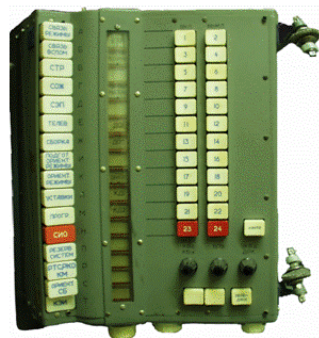
Рис. 1.3 Пульт с матричным способом выдачи команд и матричным способом вызова сигналов на контроль
