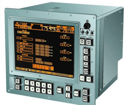
Рис. 1.4. Интегрированный пульт управления с виртуальным командно-сигнальным пультом матричного типа, диалоговой системой взаимодействия оператора и бортового комплекса, иерархической системой представления информации об объекте, процессах и окружающей среде
