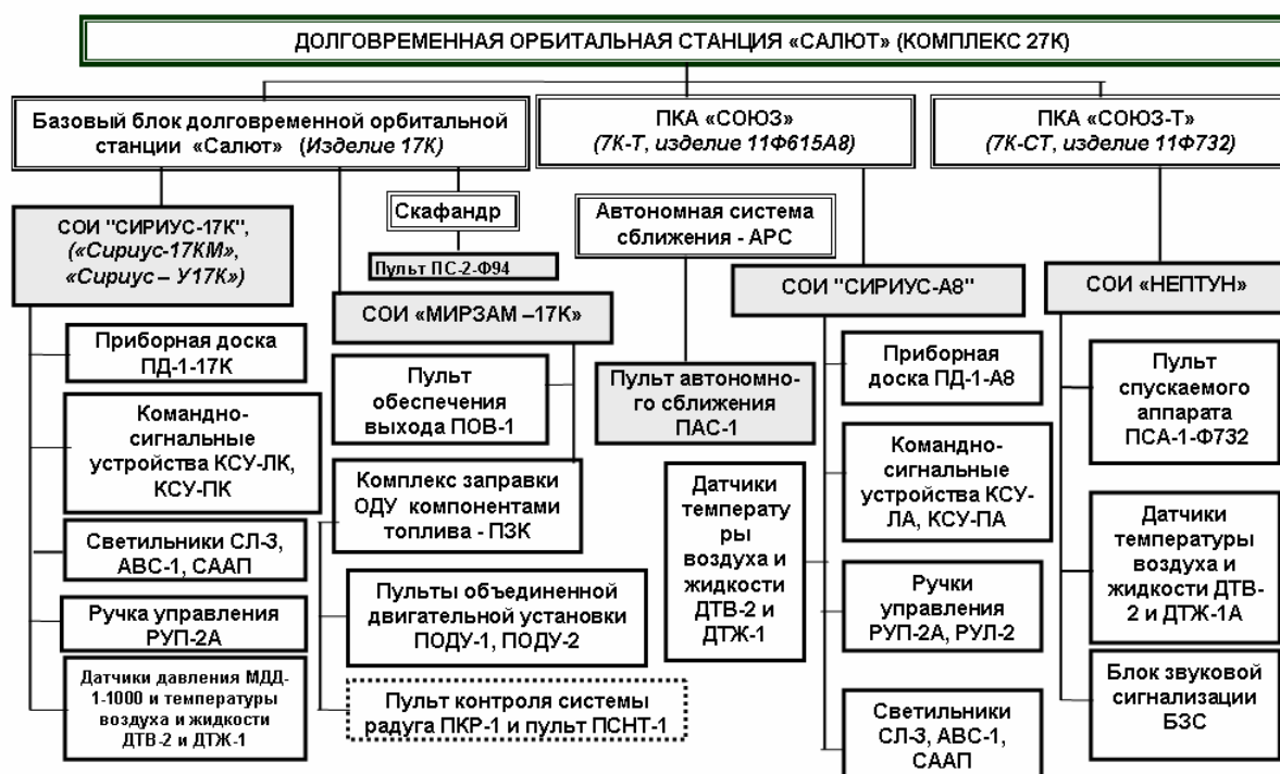
Рис.1 Состав систем отображения информации ДОС "Салют" и пилотируемых кораблей «Союз» и «Союз-Т»
