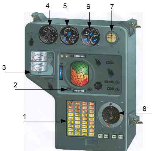
Рис. Приборная доска ПД-5-ЗКВ космического корабля ЗКВ№6 – корабля с искусственной тяжестью. 1.ТСЭ-табло сигнальное электролюминесцентное 2.ИНК-индикатор навигационный космический 3.Индикатор параметров связи СА - блок И: дальность, скорость расхождения, перегрузка 4.Индикатор давления в баллонах ТДУ, системе управления 5.Индикатор состава воздуха в кабине 6. Индикатор параметров атмосферы в кабине 7. УИТ - указатель искусственной тяжести 8. ИВК - индикатор временной комбинированный
