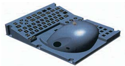
Рис.10 Устройство управления курсором и PC-подобная клавиатура для самолета Ф380 ((AW&ST июль 30, 2001, стр.42)
