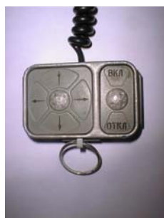
Рис.4. Блок управления маркером (курсором) системы отображения информации корабля Союз-ТМА
