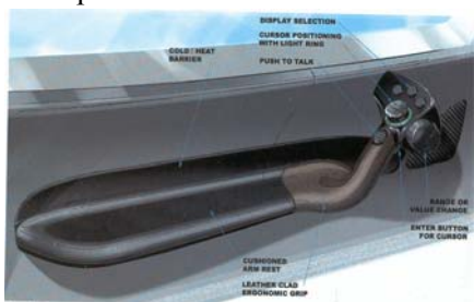
Рис. 8 Устройство управления курсором для самолета Гольфстрим (ВСА, декабрь 2000, стр.55)
