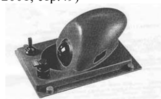
Рис.11 Устройство управления курсором фирмы Дассо (ВСА, ноябрь 2000)
